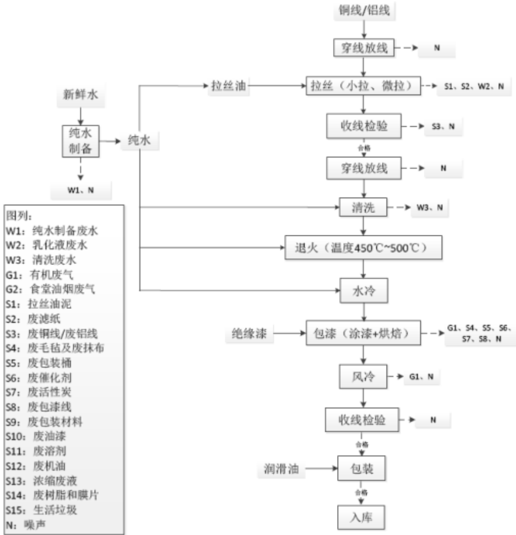
图 3.5-1 生产工艺及产污节点图
