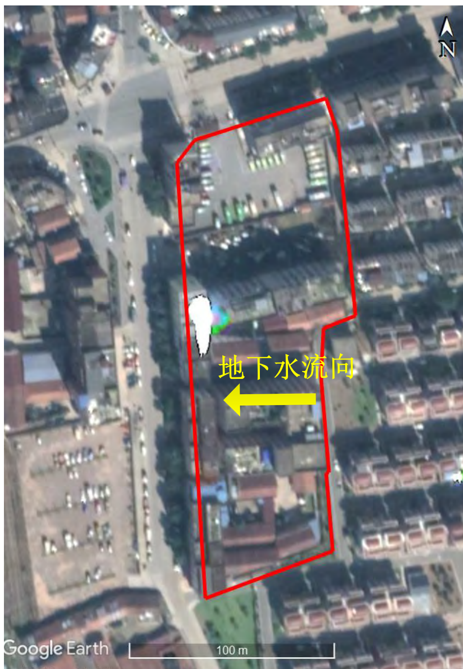
图 3.1-9 本地块地下水流向图（初判）
