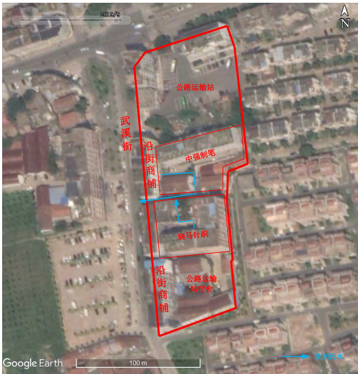
图 3.3-3 地块内原有污水管网分布示意图
