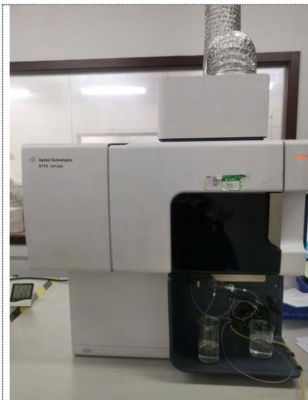
电感耦合等离子原子发射光谱仪
